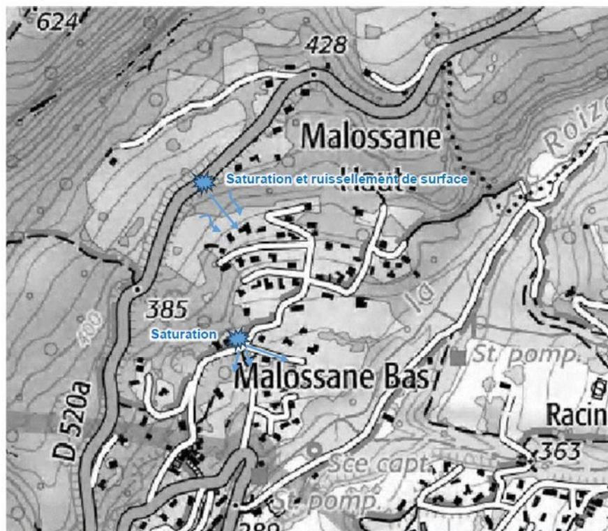
Figure 12 : Phénomènes de ruissellement observés sur les quartiers de Malossane le Haut et Malossane le Bas
