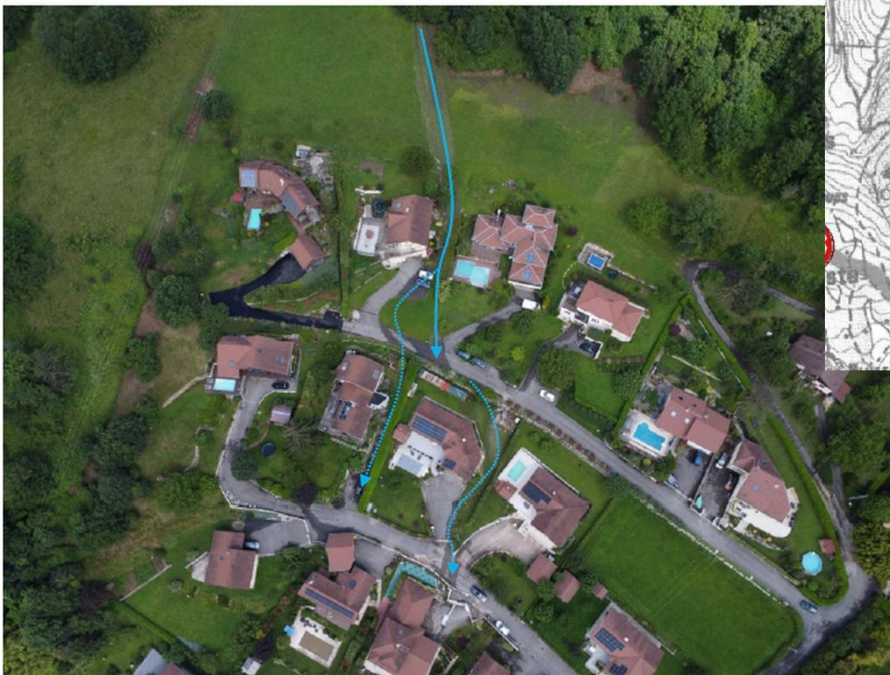
Photo 49 : Cheminement des écoulements dans le quartier de Malossane le Haut (photo RTM, 10/06/2024)
