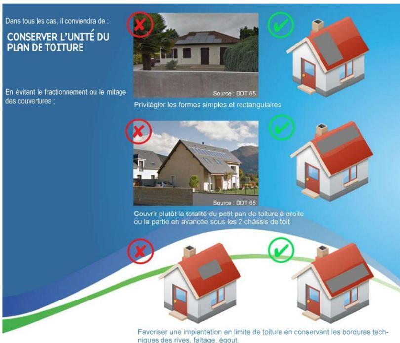
Figure 67. Intégrations des panneaux photovoltaïques ou thermiques en toiture, à privilégier ou à éviter
