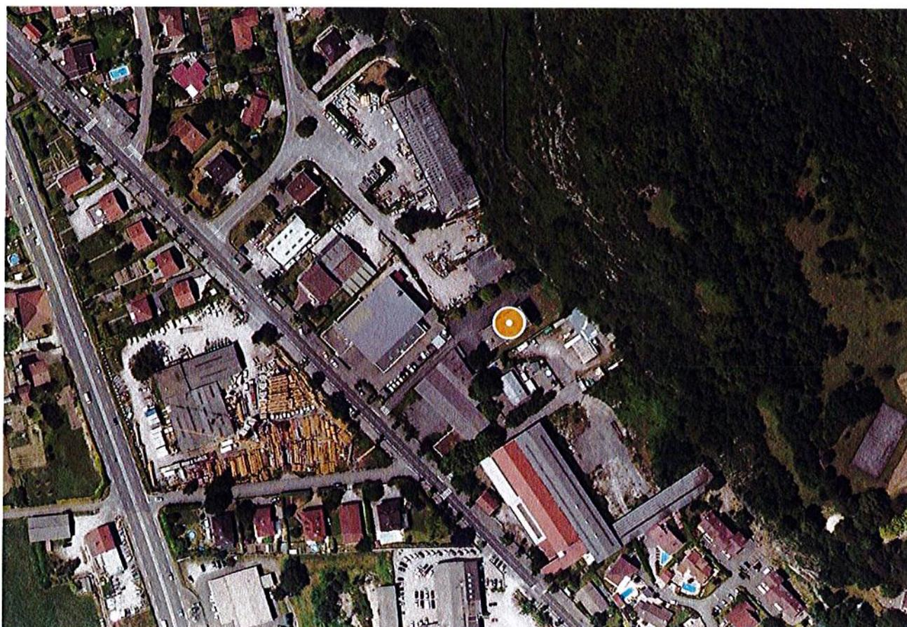
Il n'y a pas d'ouvrant dans un rayon de 10m de l'antenne.
